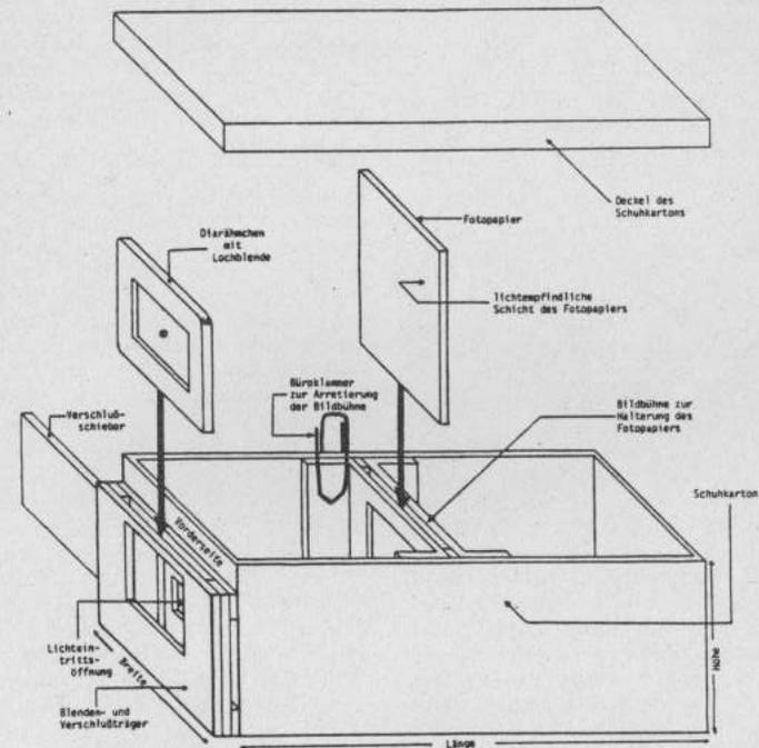
Mit der abgebildeten Lochkamera werden wir fotografieren. Bau sie zunächst aus einem alten Schuhkarton nach!
